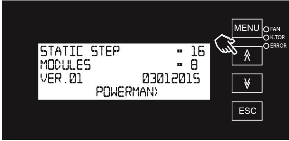
Resim7: Yukarı ok tuşuna basılınca LCD Panelde görüntülenen bilgiler
