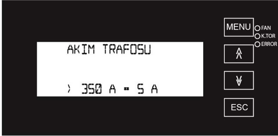
Resim11: Akım trafosunun deęiřimi
